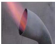
チラノ繊維使用の複合材の排気管モデル
