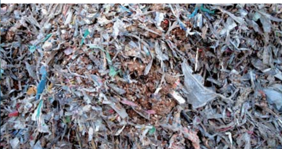
利用前の廢プラ。金属片などの異物除去が必須
