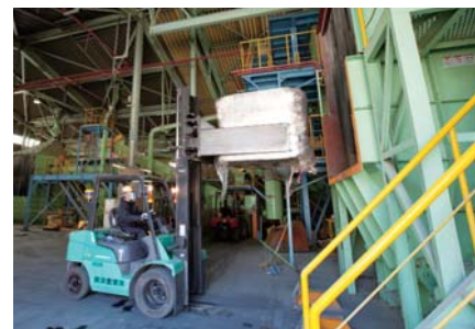
廢プラを処理設備に投入
