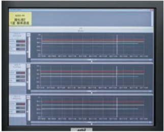
計器室の監視画面。縦の白いラインより左側が実際にセンサーから送られてきた温度や圧力のデータ。それをもとにITで解析し、右側の将来の変化を予測します。
