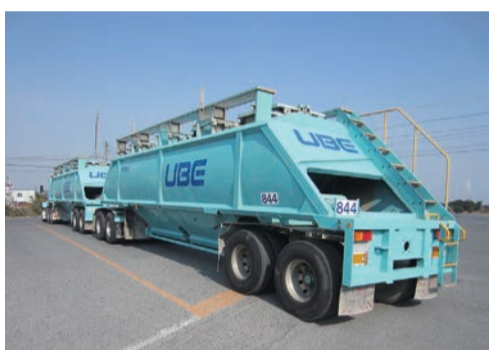
ダブルストレーラー(写真の牽引車はケンワース製) 全長30メートル、総重量117トン。 タイヤの数はなんと34本も。
